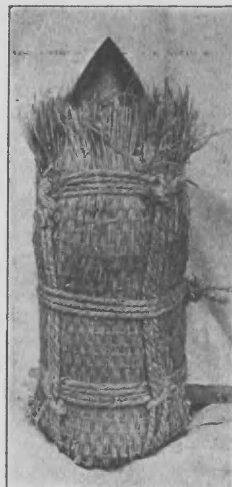
大口徑彈丸莖包荷造(近距離用)ノ一例
